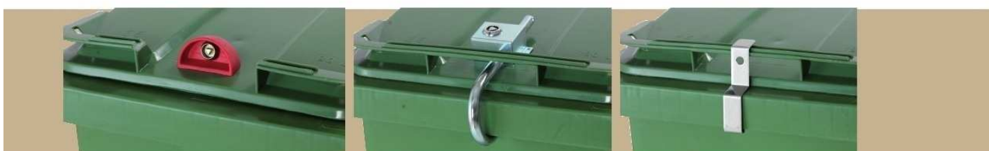
Gravitationslås Gravitationslåset låser op af sig selv når beholderen når en bestemt vinkel i tømningscyklus. Beholderen låser sig når det stilles tilbage på jorden. Nøgler behøves ikke for tømningspersonalet, nøglen opbevares af kunden. Art.nr 844 140
